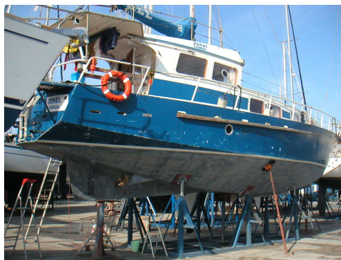
Carénage - antifouling au zinc silicaté
